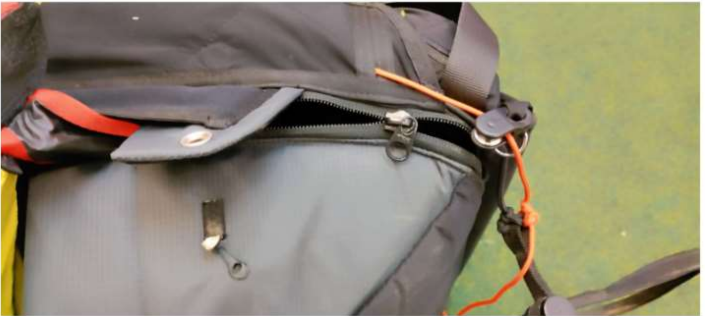
Illustraties : moeilijke of geblokeerde opening door een gedeeltelijk geopende ritssluiting.
